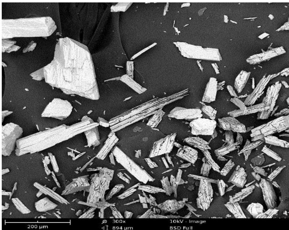
Zeólita tratada com ácido clorídrico, aproximação 1250x, 10 kV.
